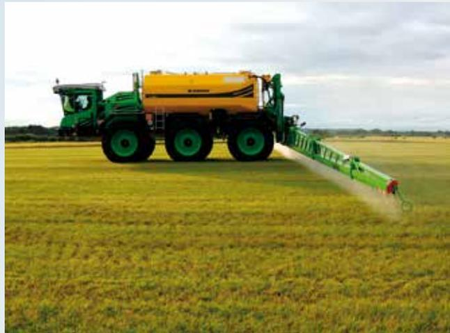
Die Hydraulikpumpen für Fahrtrieb und Aufbaugerät werden durch einen 230 kW (313 PS) Motor von MTU angetrieben. Der 6R1000 Motor von MTU wird lastabhängig elektronisch geregelt, je nach Hydraulikbedarf. Optional kann der DT 3500H auch mit einem größeren Motor, dem MTU 6R1000 mit 260 kW (350 PS) ausgestattet werden. Beide Motoren sind mit SCR-Katalysator und erfüllen die Abgasstufe EU Stufe IV, sowie Tier IV final.
