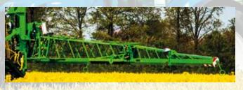
Variante 2: Dreiteiliges Gestänge mit einem 3 m Gestänge, dass auf dem Ende des zweiten Auslegers liegend positioniert ist. Diese Variation gibt es als Gestängetyp 15/30/36 Meter Arbeitsbreite. Die Anfahrsicherung sitz direkt am dritten Ausleger.
