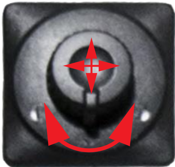
68. ábra. A tetőkonzol elektromos visszapillantó tükör beállító kapcsoló
