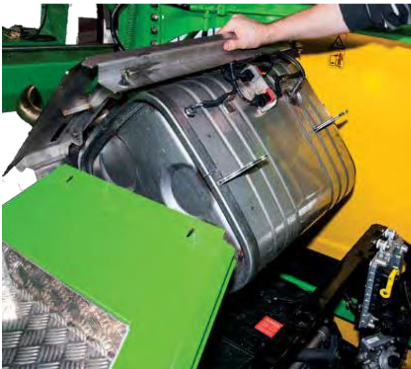
75. ábra. SCR-Katalizátor az oldalhoz kihajlítva DT 2500H S4
