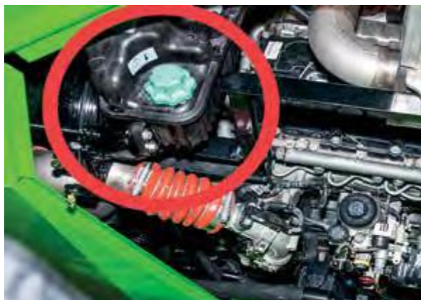
10. ábra. Hűtőfolyadék kiegyenlítő tartály DT H S4
