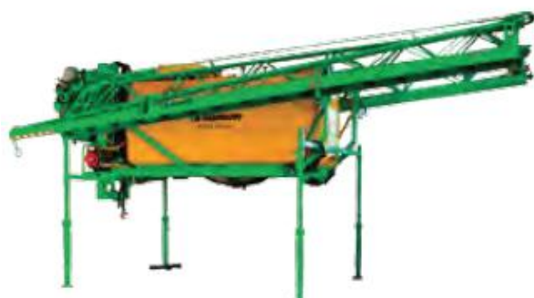
92. ábra. DTP tárolóállványra helyezése
