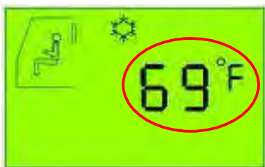
85. ábra. A beállított hőmérséklet °Fahrenheit fokban
