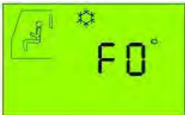
86. ábra. Klímaberendezés hibakódja F0
