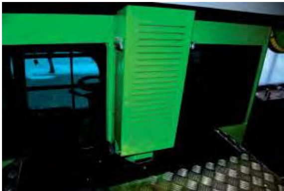
89. ábra. Szűrőegység zárófedelének nyitása.
