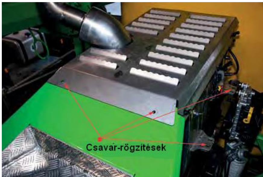
72. ábra. SCR-katalizátor csavar-rögzítései DT 2500H S4
