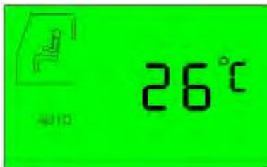
79. ábra. A klímeberendezés kijelzője 26°C fokot és automatikus üzemmódot mutat
