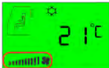
83. ábra. A klíma ventilátor fordulatszáma 100%-ra beállítva » Megjegyzés:
