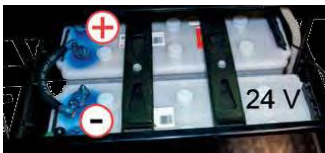
13. ábra. 24 V –os akkumulátor
