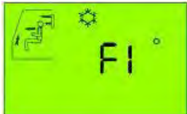
87. ábra. Klímaberendezés hibakódja F1
