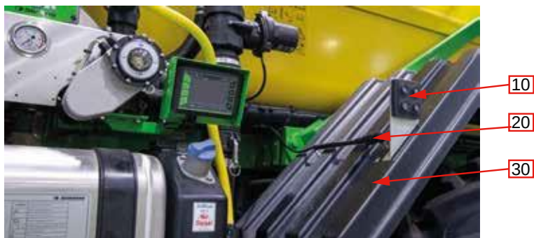
175. ábra Sárhányó csatlakozójának kioldása
