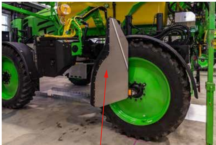
155. ábra Műanyag kerékvédő leszerelése
