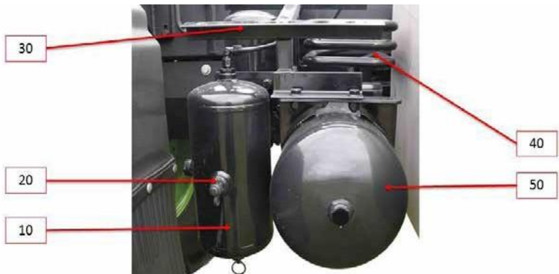
33. ábra Sűrített levegős rendszer DT 2800H
