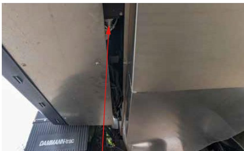
198. ábra ISOBUS-csatlakozó kioldása
