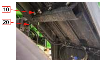
176. ábra Bal hátsó sárhányó eltávolítása
