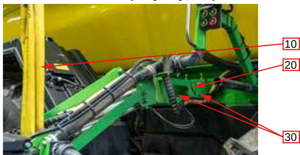
190. ábra Vegyszerbekeverő központ előkészítése
