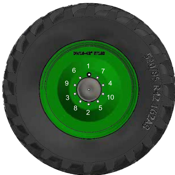
234. ábra Kerék meghúzási sorrend
