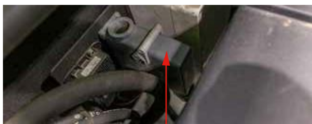
185. ábra Jármű-eszköz csatlakozót kioldjuk
