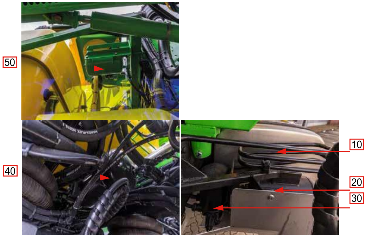
32.ábra Sűrített levegős rendszer DT 2400H
