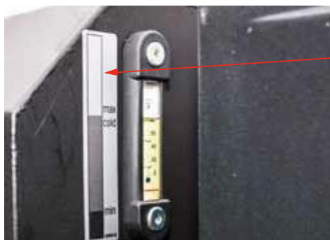
214. ábra Hidraulika olajszint ellenőrzése
