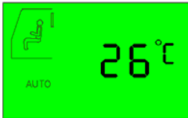
88. ábra A klíma berendezés kijelzője 26°C fokot és automatikus üzemmódot mutat
