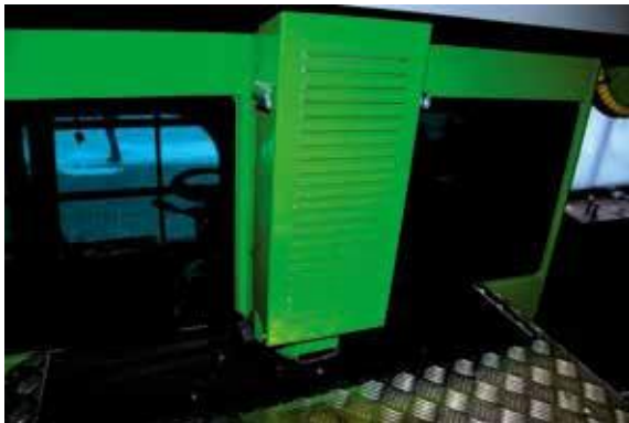
222. ábra Szűrőegység zárófedelét kinyitjuk
