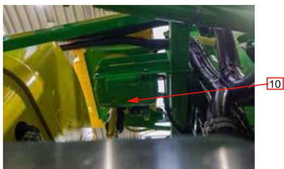
164. ábra Sűrített levegő póttartályt levegőtleníteni
