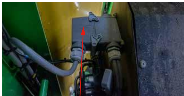
199. ábra Elektromos csatlakozót kioldjuk
