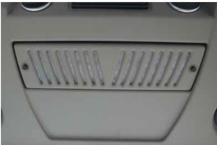
227. ábra Klímarendszer finomszűrője
