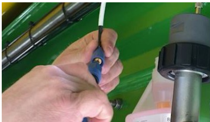
57.ábra A kábelt a szenzorral összecsavarozzuk
