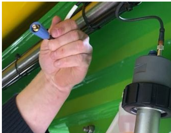
55. ábra Szenzorok kábelét szétcsavarozzuk
