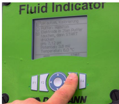
97. ábra: F3 gombbal indítsa a kalibrálást
