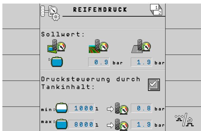
75. ábra: Beállítások 1. oldal nyomásvezérléssel, a tartály tartalmával
