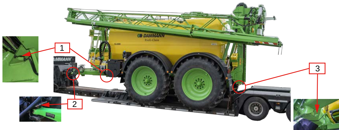
53. ábra: Rögzítés mélyrakodón tengelykapcsolóval (például ANPT)
