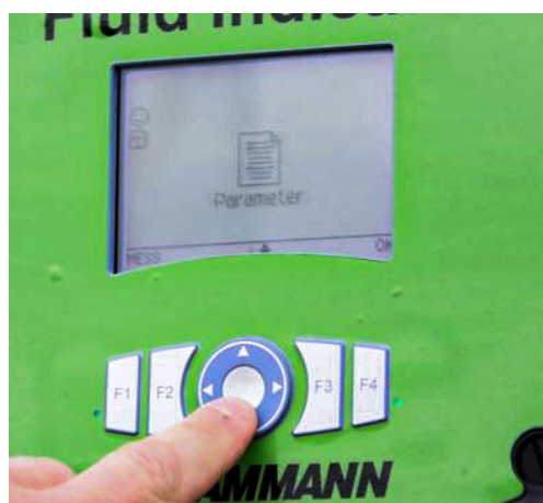
94. ábra: Nyílgyombokkal válassza ki a kalibrálást
