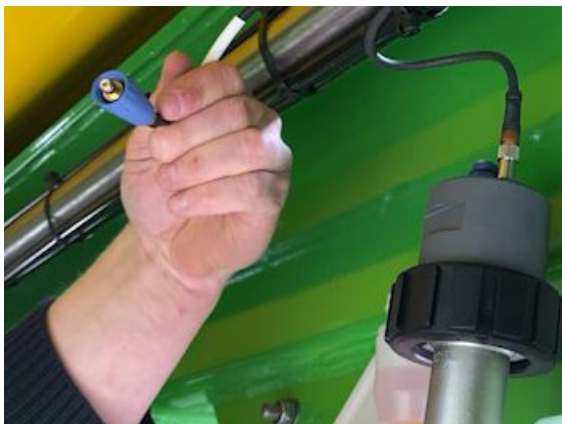
89. ábra: Csavarozza le az érzékelő kábelét
