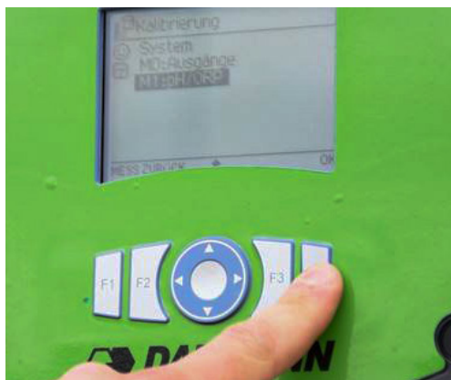
95. ábra: „M1:pH/ÖRP” kiválasztása és megerősítése
