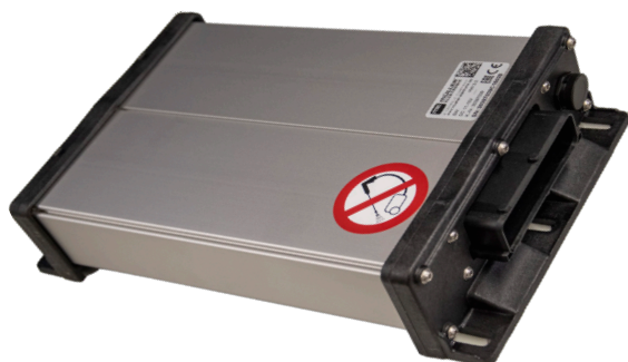
45. ábra: ISOBUS munkaszámítógép JR MIDI universal
