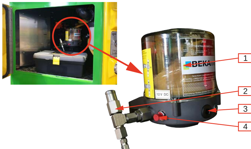
116. ábra: Töltse fel a központi kenőrendszert
