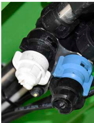
21. ábra: PWM tandem fúvókatartó
