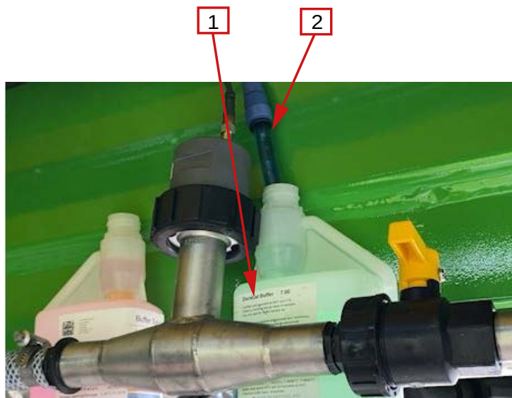
99. ábra: Az érzékelő pH 7-es pufferoldatba helyezése
