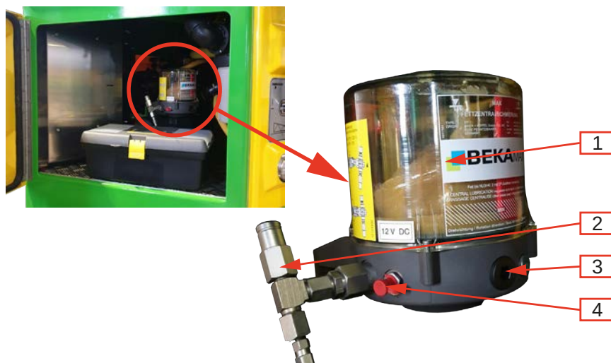
116. ábra: Töltse fel a központi kenőrendszert
