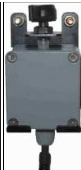
8-3. kép: Elhajlásmérő rögzítővel
